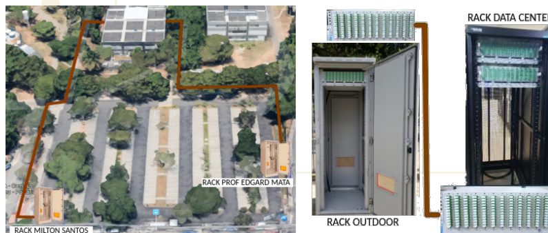
Figura 1. Interligação pelos dutos dos racks externos aos internos no data center
